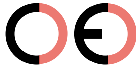
Falsche CE-Kennzeichnung (zu großer Zwischenraum)
